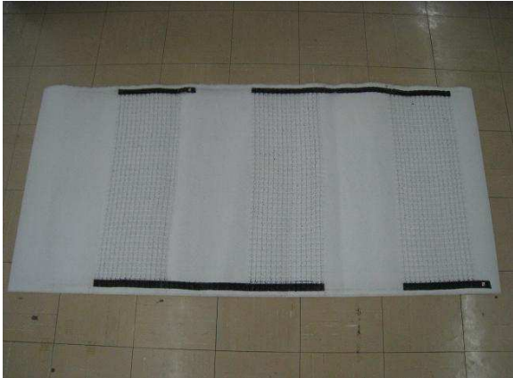
発熱ネットをシートに貼り付け
